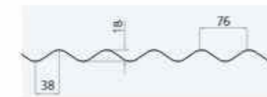
Iron Anchura de la lámina: 1260 mm
