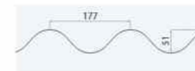
P0007 Anchura de la lámina: 1100 mm
