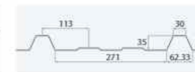
P0619 Anchura de la lámina: 1046 mm
