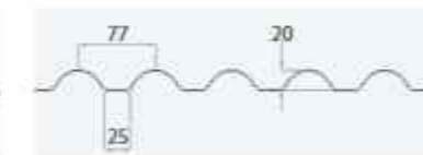
Omega Anchura de la lámina: 1135 mm
